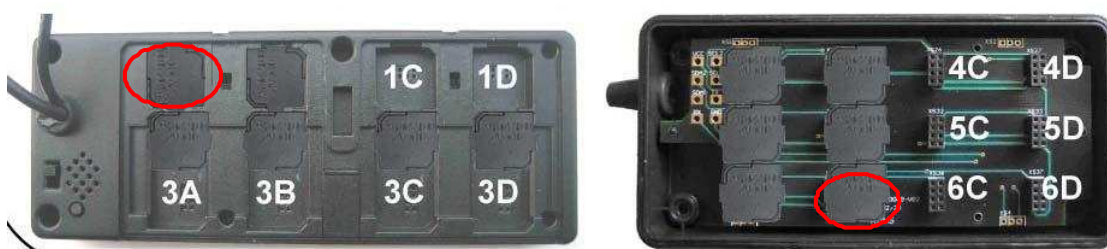
Obrázok 5.8 Vzájomná zámena ID modulov a reštart systému
