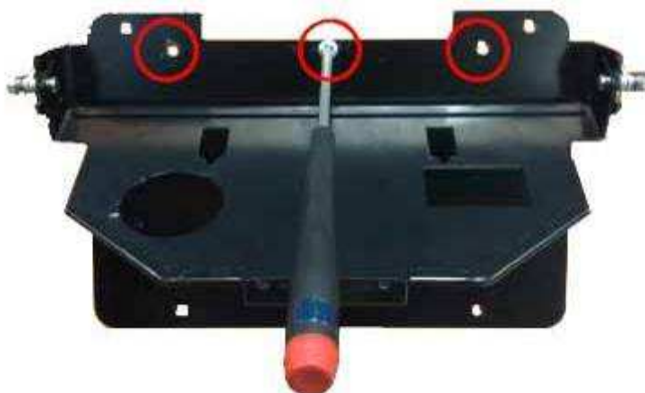
Obrázok 1 – upevnenie pántu na sedačku pomocou skrutiek
