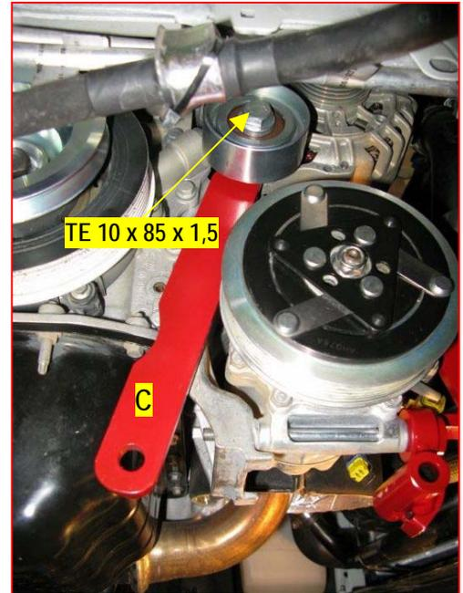
9. Montare il puntone D con le due viti TE indicate in foto n. 6;
